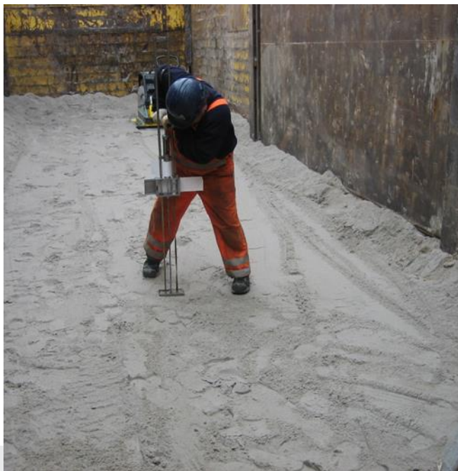
Foto: Voorbeeld van een controlemeting van de indringweerstand.
